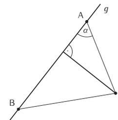
Beschreibt  $\alpha$  den Winkel zwischen den Vektoren  $\vec{AC}$  und  $\vec{AB}$  im Dreieck, so berechnet sich der Abstand von C zur Geraden durch A und B als
