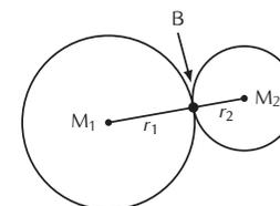
Der gesuchte Punkt  $B$  liegt auf der Strecke zwischen  $M_1$  und  $M_2$ . Der Abstand von  $M_1$  zu  $B$  entspricht dem Radius  $r_1$ . Somit wird der Vektor  $\vec{M_1M_2}$  auf  $r_1$  skaliert und zu  $M_1$  addiert.
