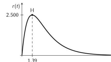
Mithilfe eines GTR erhält man  $t_0 \approx 1,39$  als den Zeitpunkt mit der maximalen Zuflussrate. Diese beträgt dann 2500 Liter pro Stunde.
