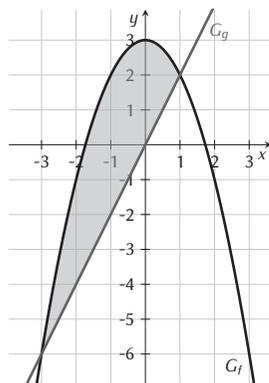
Der Flächeninhalt  $A$  der, von den beiden Graphen eingeschlossenen, Fläche lässt sich als Integral der Differenz der Funktionen zwischen den Schnittstellen berechnen:
